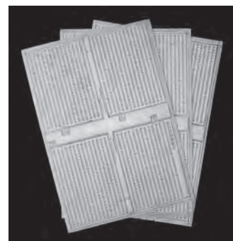
明治時代の紙型(『承陽大師聖教全集』) 組み上げた金属活字原版を型取った紙製の鋳型。印刷の近代化に伴い、原版の複製を作ることが可能にした。
